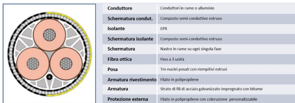
Figura 3.6: Esempio di cavo di collegamento a 66 kV e tipico di sezione
